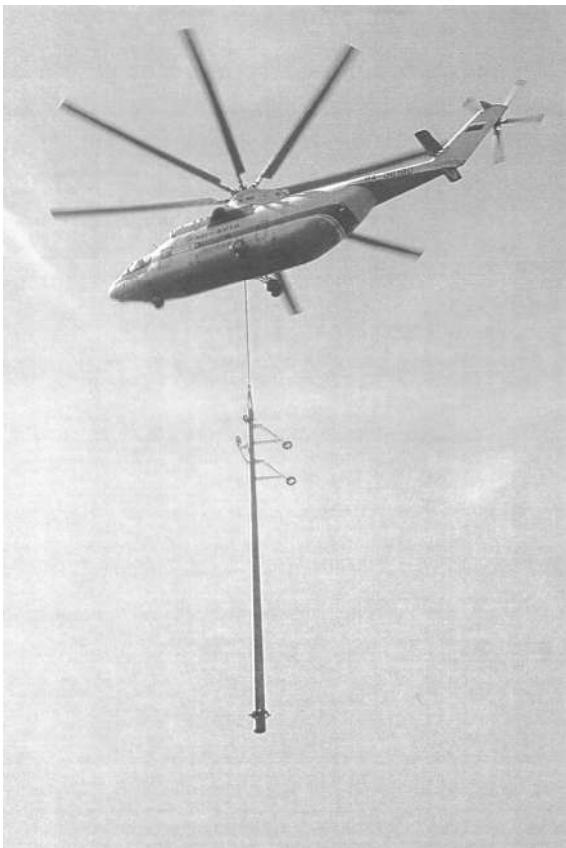
Bilden ovan visar världens största helikopter med 130 kV ledningsstolpe (vikt ca 25 ton)
