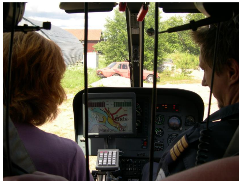
Locator X, direkt uppladdning från MapInfo- filen, invisning för piloten och avrapportering av flygrutten tillbaka till MapInfo
